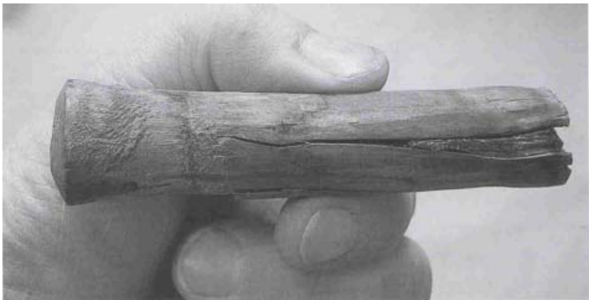
Denne lille "blindnagle" af enebær har siddet i en klækbygger båd, formodentlig norskbygger. På dens ene ende har naglen en kile, på den anden en svagt fregnet hals og et hvarvet hoved. Halsen og hovedet gjorde den nødvendige kile overflødig. Naglen sad i et vrug, der dikkede op af sandet på Uggerby strand for 20 år siden. Foto: Tom Rasmussen
