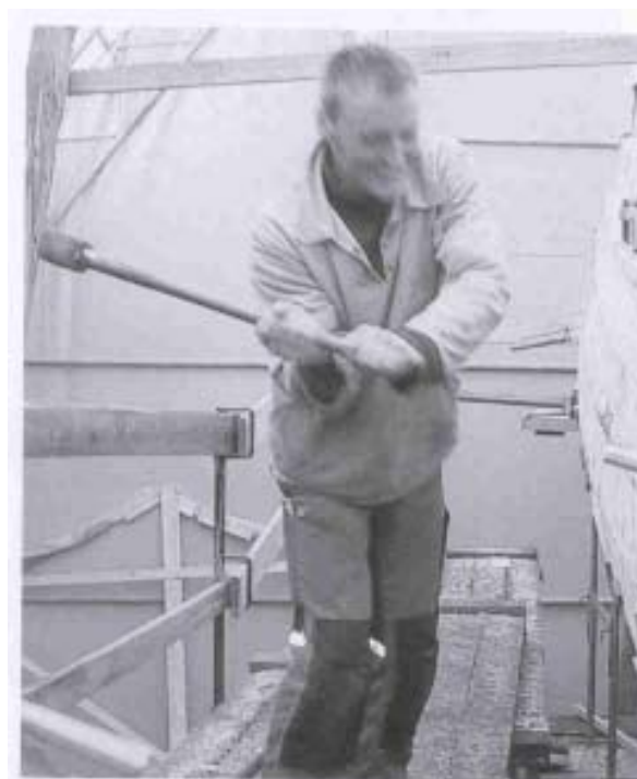
Trænaglerne bliver slået ind med en smikkert. Naglen kan som brikke sættes under slagene, og derfor blev der i ældre tid gerne viklet nogle omgange med merling om enden. Normalt blev breenen hal eller nogle smart inden monteringen, men JENSINES nagler blev dyppet i linolie. Ved Ring-Andersen blev der f.eks. brugt Black Varnish.
